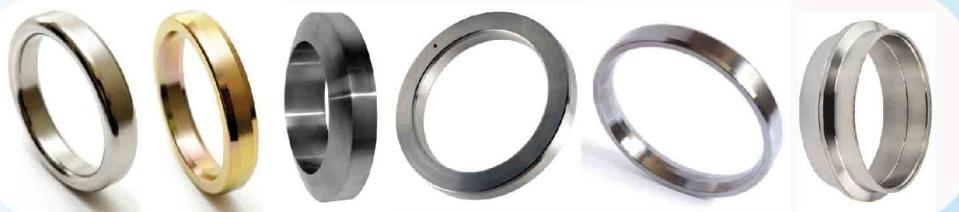
**ВАЖНО:** для металлических прокладок твердость металла прокладок должна быть ниже твердости фланцев не менее чем на 20 НВ по Бринеллю.
